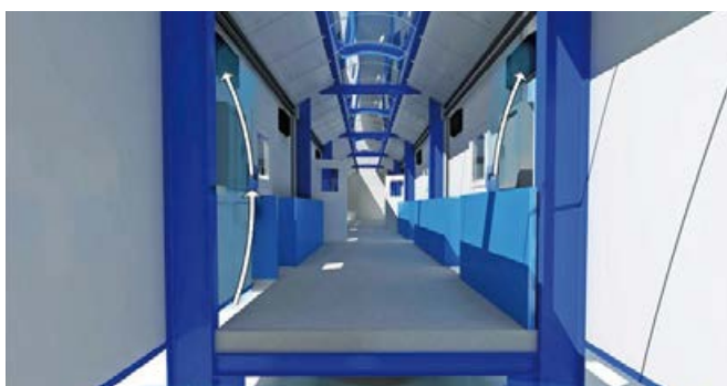
Couloir central et répartition de la ventilation vers les logettes.
