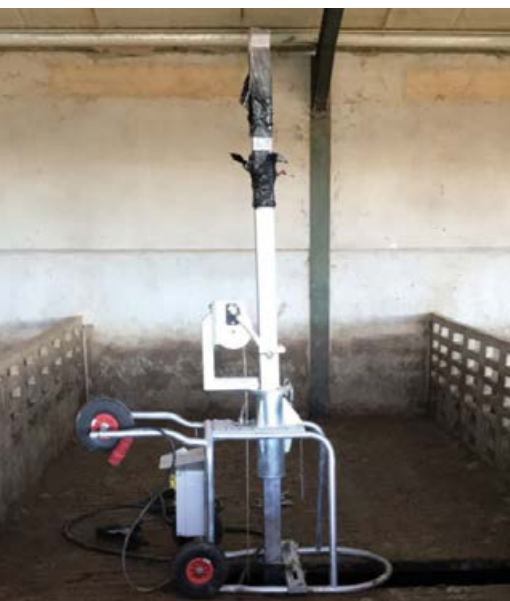
MIXEUR DANS UNE FOSSE INTÉRIEURE
